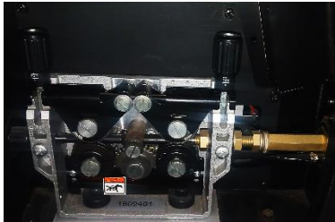
Motor de alimentador con 4 rodillos para mejor arrastre.
